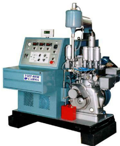
1-rasm. UIT-85M Dvigatel yoqilg'ilarining oktan sonlarini aniqlash uchun mo'ljallangan qurilma
