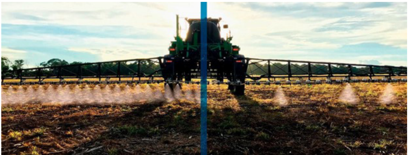
4-rasm: Sensorga asoslangan tizim (O'ng tomonda o'zgaruvchan me'yorlarni qo'llashga asoslangan sepish usuli, chap tomonda an'anaviy usul)
